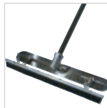
Flotador tipo escoba de Fresno Herramienta combinada (para enrasar y acabar) capaz de aplicar un cepillado final uniforme Ancho: 900 mm.; peso de la cabeza: 4,8 kg.
